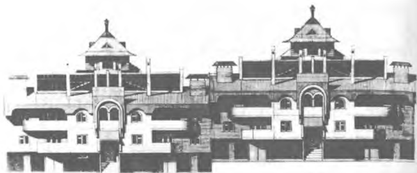
Рис. 5. Главный фасад экспериментального дома (план дома см. на рис. 4). Во внешнем облике дома использованы элементы, восходящие к традиции стационарных объектов калмыцкой архитектуры.
